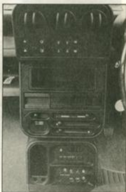
儀錶板的局部特寫。出風口現在可以完全關密。
